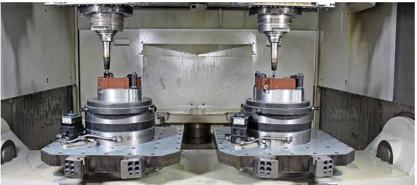
Das Chiron-Bearbeitungszentrum DZ 25 P five axis hat einen Spindelabstand von 800 mm.
