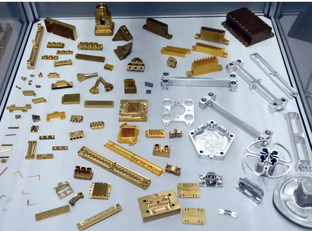
1 Präzisionskomponenten für hochgenaue Test- und Prüftechnik: Rosenberger setzt infolge zunehmender Miniaturisierung in den Hochvoltanwendungen auf eine weitgehende Komplettbearbeitung mithilfe zweier 5-Achs-BAZ 'FZ 12 S five axis' der Chiron Group © Hanser
