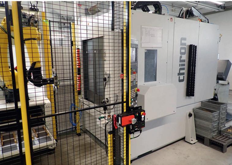
4 In Eigenregie adaptiert Rosenberger eine robotergestützte Automation mit Rohteilhandling an eine der FZ 12 S five axis; beide Chiron-Maschinen bringen dafür von Haus aus alle notwendigen Voraussetzungen mit © Rosenberger
