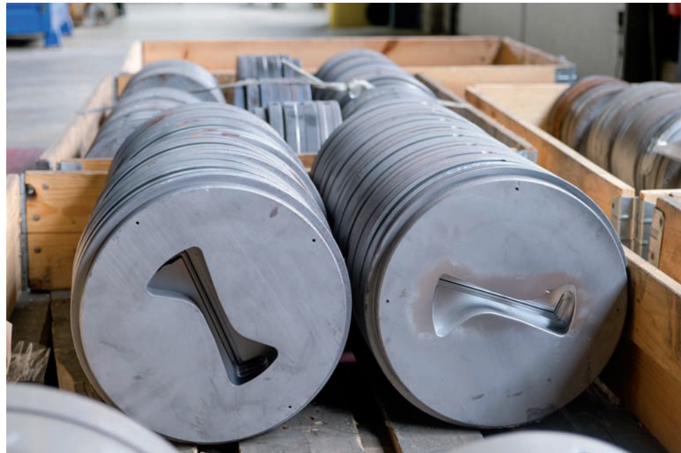
Nordalu presst Aluminiumbolzen zu Profilen von 15–180 mm Ø und Wandstärken bis runter auf 0,8 mm. Von einfachen bis hochkomplexe Strukturen in verschiedenen Legierungen ist Nordalu spezialisiert auf kleine Mengen ab 250 kg.
