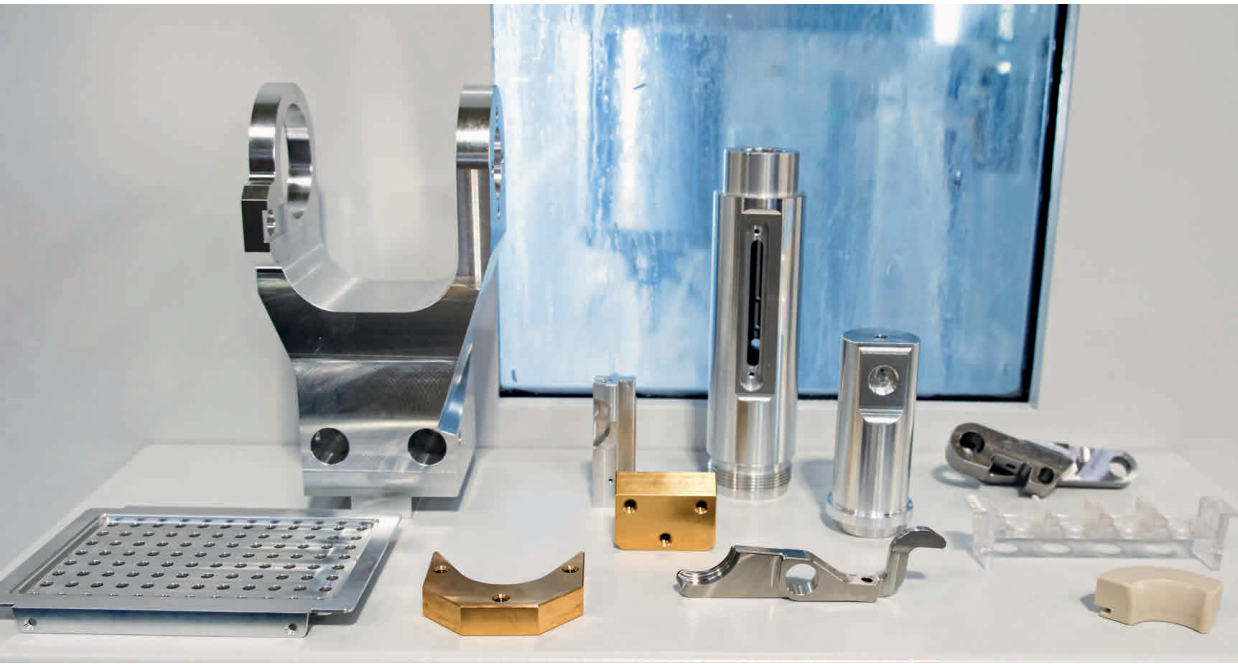
1 Prototypen- und Serienfertigung, Aluminium, Edelstähle, Kunststoffe, Messing, Titan, CoCr, 3- bis 5-achsiges Fräsen und Drehen: das aktive Teilespektrum, das Lothar Karl Feinmechanik fertigt, umfasst gut 15000 Teile © Chiron
